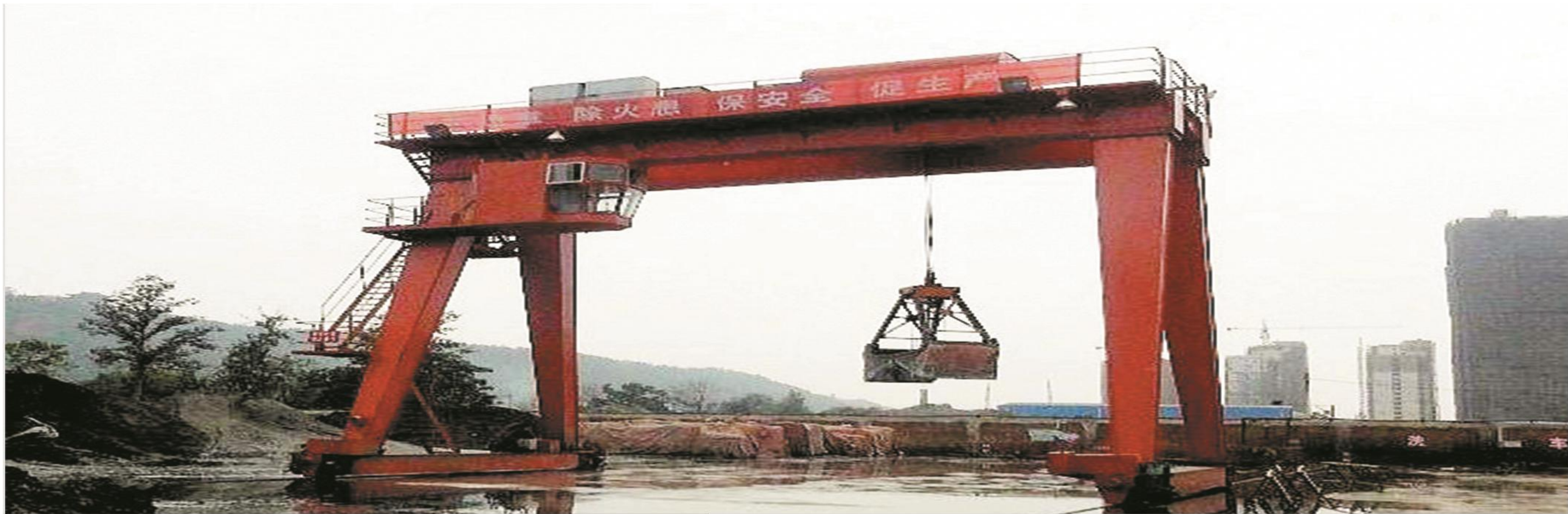
MZ型通用门式起重机 MZ universal gantry crane 起重量 Lifting weight: 1~75t 工作级别 Work level: A5
